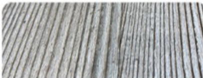
j-Wall: Kendimize özgü tekniklerle oluşturduğumuz karışımı yüzeye uygularız ve 24 saat sonra ağırtılmış bir yüzey elde ederiz. Bu yüzeye beyaz patina uyguladıktan sonra oluşan renktir.
